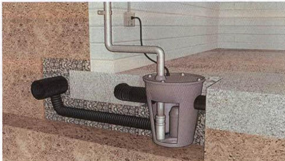
*Bombeo de caudales infiltrados por nivel freático desde los drenajes perimetrales*
